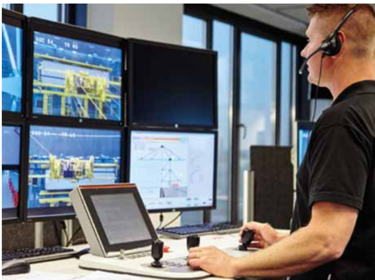
Rys. 5.17 Kabina operatora automatycznych urządzeń ładunkowych [91]
